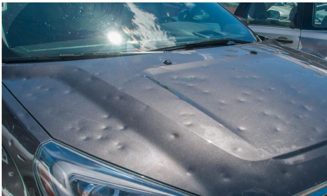
Abbildung 1: Hagel-„Dellen“ an einem Fahrzeug
