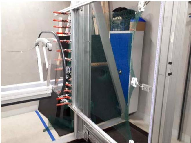
Abbildung 3: Hagelschlagkanone im Prüflabor (Quelle: TÜV Rheinland)
